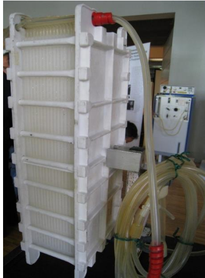
Fig.4. Filtro RP6 a piastre, preassemblato con membrane di Cuprophan, sterile e monouso, produzione Rhone Poulenc francese. Superficie di scambio di 1 mq, fin da allora considerata lo standard per una depurazione adeguata.
